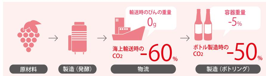
そこでメルシャンでは、輸入ワインの一部において、輸入先で酸素透過性の低い24kL(750mlびん換算で約32,000本分)の大容量の専用バッグにワインを詰めて、これを海上輸送し、日本国内の工場ではボトリングを行っています。国内でボトルに詰めるため自社の工場内でのCO<sub>2</sub>排出量は増えてしまっていますが、重いボトルを輸送する必要がなくなるため、ボトルに詰めた状態で輸入する場合と比べて海上輸送時のCO<sub>2</sub>排出量を約6割削減することができます。さらに日本でボトリングすることで、エコロジーボトル(再生ガラスが90%以上使用されているもの)や、軽量ボトル、ペットボトルを使用することも可能となり、資源の有効活用になるとともに、バリューチェーン全体でCO<sub>2</sub>排出量を大きく削減することができます。
