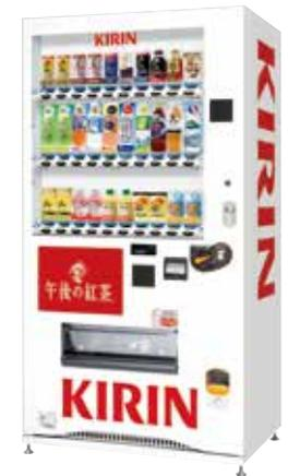
年比で約40%の電力使用量を削減できるまで進化しています。最新式の「ヒートポンプ式自動販売機」の特徴として、インバーター制御により最適効率の回転数を可変するコンプレッサーを搭載しています。一部のタイプは庫内だけでなく、庫外の熱を奪って加温する機能や真空断熱材の多用による保冷・保温能力の向上により省エネ性能を高めています。また、キリンビバレッジでは2013年から新規導入しているすべての缶・ペットボトル自動販売機の照明に「LED照明」を採用しています。
