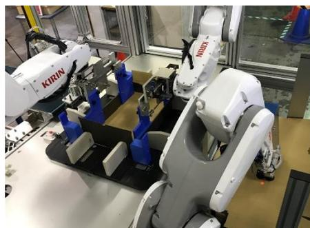
ロボットによる内箱形成作業
